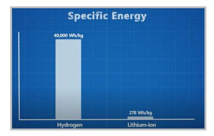
Die derzeitige Lithium-Ionen-Batterien, natürlich hängt es hier auch davon, welches Kathoden- und Anodenmaterial genutzt wird und welche weitere besondere Komponenten verwendet werden, etwa, wenn ein Festkörperelektrolyt statt einem flüssigen Elektrolyten genutzt wird, haben eine extrem geringe spezifische Energie im Vergleich zur Wasserstoffbrennzelle.
